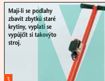
3 Mají-li se podlahy zbavit zbytků staré krytiny, vyplatí se vypůjčit si takovýto stroj.
