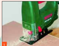
1 Elektrická pila děročka je opravdu univerzální nástroj. Může provádět rovné, ale i zakřivené řezy.
