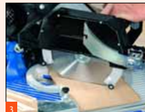
3 Výhoda zarovnávačky a pokosové pily spočívá v tom, že se pohybuje neobkolem, ale list pily. Díky tomu se podaří obzvláště přesné řezy.
