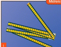
1 Skládací metr je nejobvyklejší měřicí nástroj. Jeho čepy by měly být občas trochu naolejšovány.
