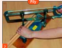
2 Pokosová pila přichází ke slovu hlavně při připevňování podlahových listů. Má vedení a nechá se nastavit na různé úhly.
