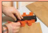
Nepřavidelné obrysy – zde například dvou trubek – se dají přesně sejmout a přenést obrysovou šablonou s posuvnými plastovými destičkami.
